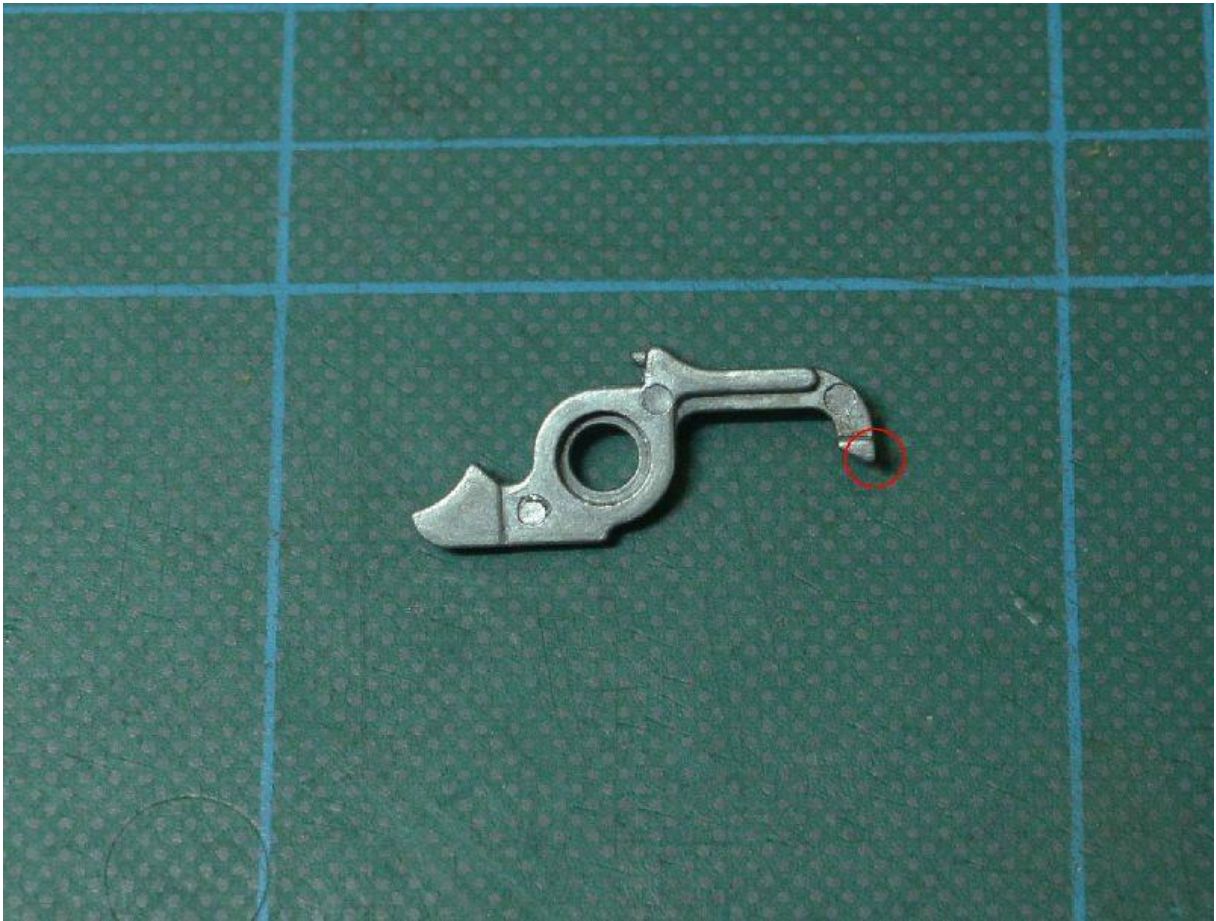
fig.3 カットオフレバーですが、カットオフレバー検出スイッチに 触れる面にバリが出ていると破損に繋がるので適度に面取りしておきます。 (CNC削り出しの場合は特に念入りに面取りしてください)
