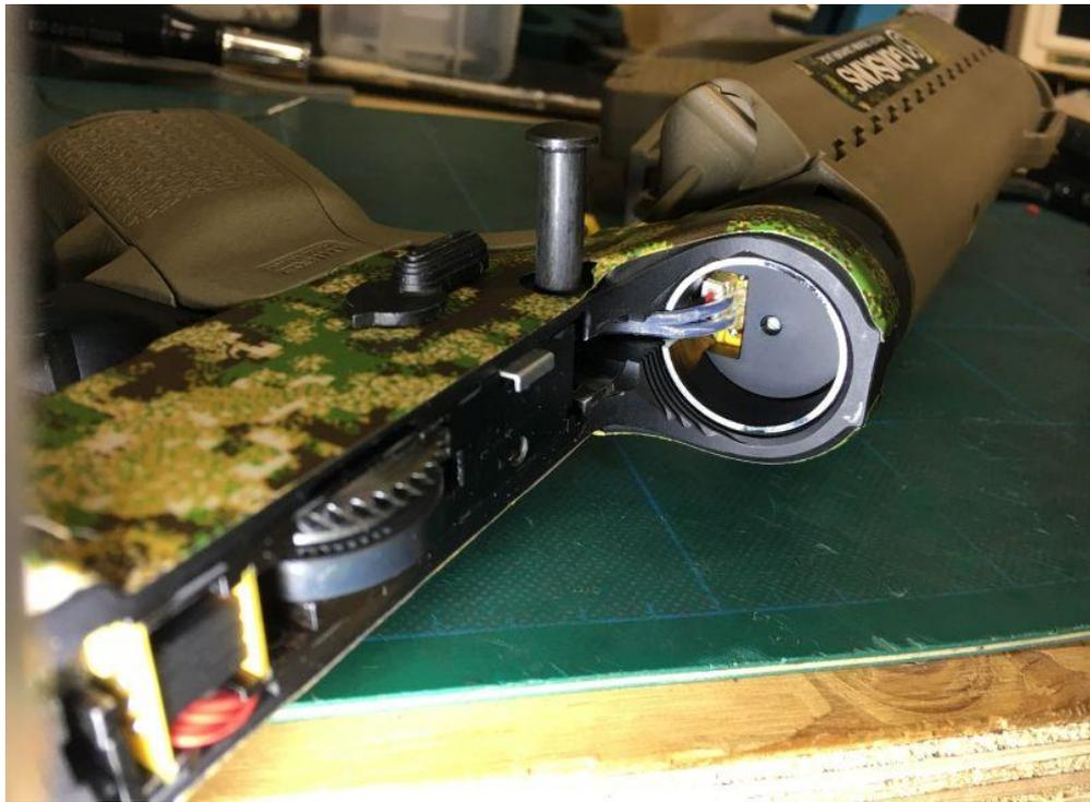
お好みの信号線を取り付け、バッファチューブ内に設置します。
